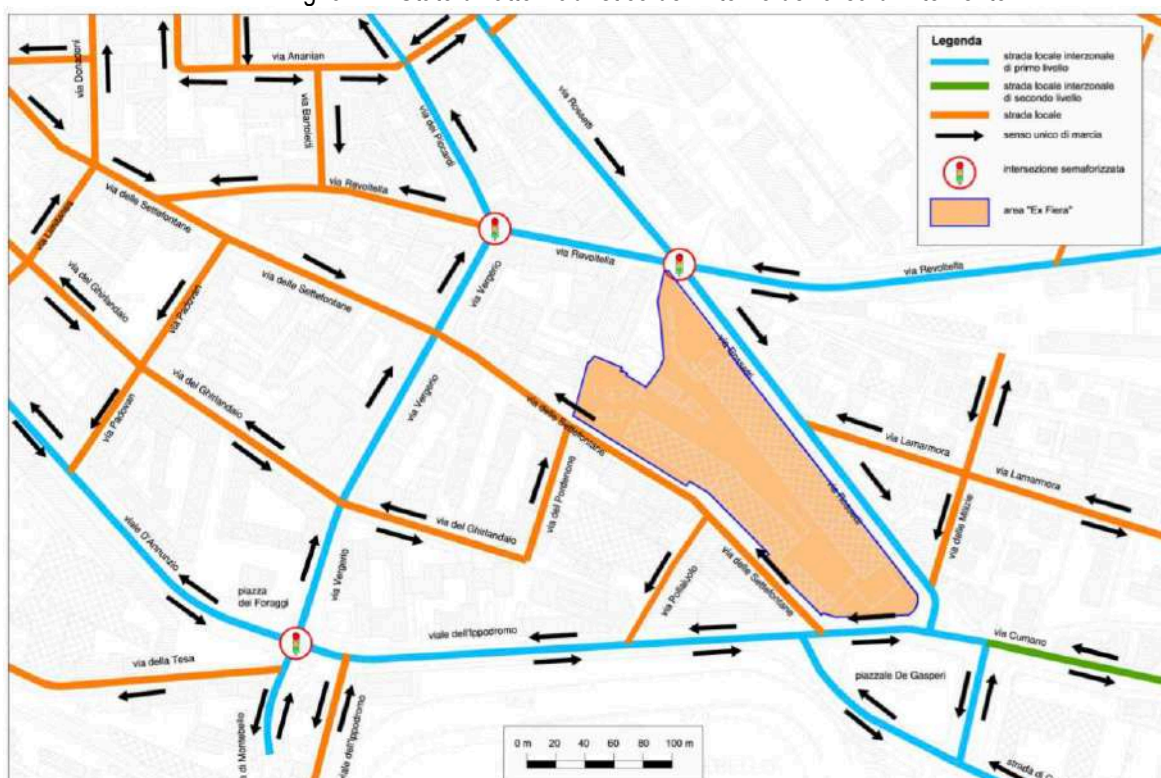
Fig. 9.14 - Stato di fatto viabilistico dell'intorno dell'area di intervento
