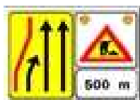
Esempio di presegnale di cantiere mobile
