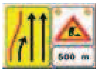
Esempio di presegnale di cantiere mobile
