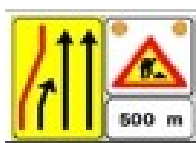
Esempio di presegnale di cantiere mobile
