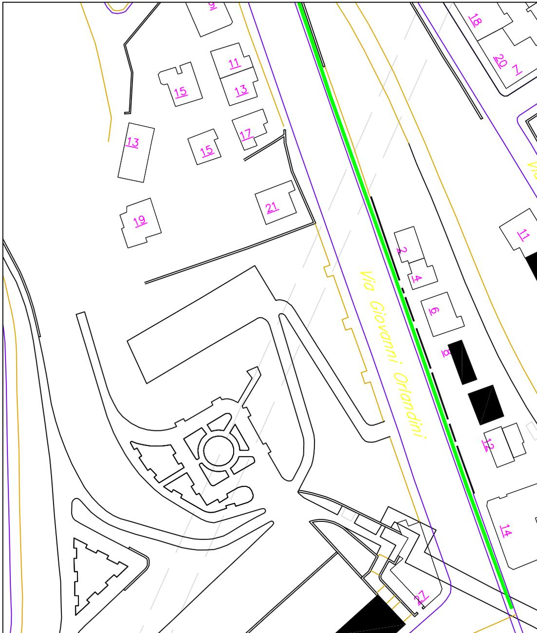
Rifacimento completo del marciapiede in via Orlandini compresa la demolizione, la posa delle cordonate, il rifacimento del sottofondo e del tappetino per una lunghezza complessiva stimata di 230 ml.
