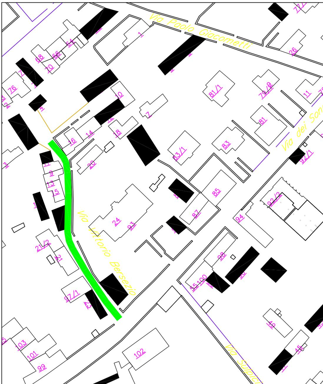
Fresatura del manto bituminoso, verifica del sottofondo, con eventuale risanamento dello stesso e successiva asfaltatura compresa la sostituzione dei chiusini danneggiati. Superficie presunta 450 mq.
