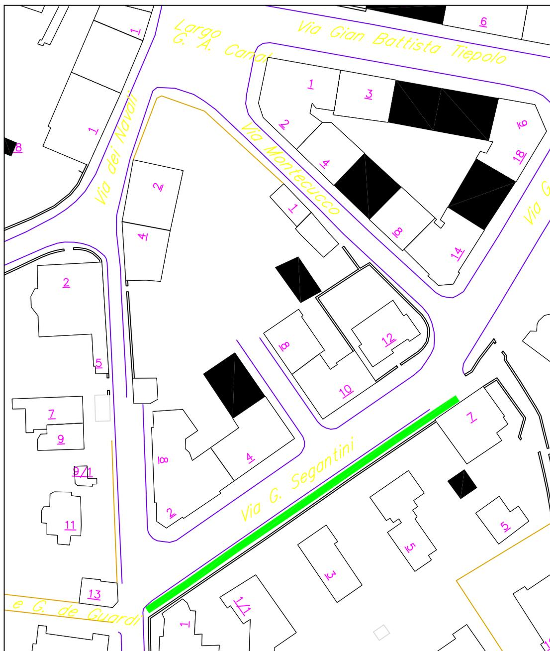
Smantellamento e rifacimento completo del marciapiede in conglomerato bituminoso. Superficie presunta 140 mq.
