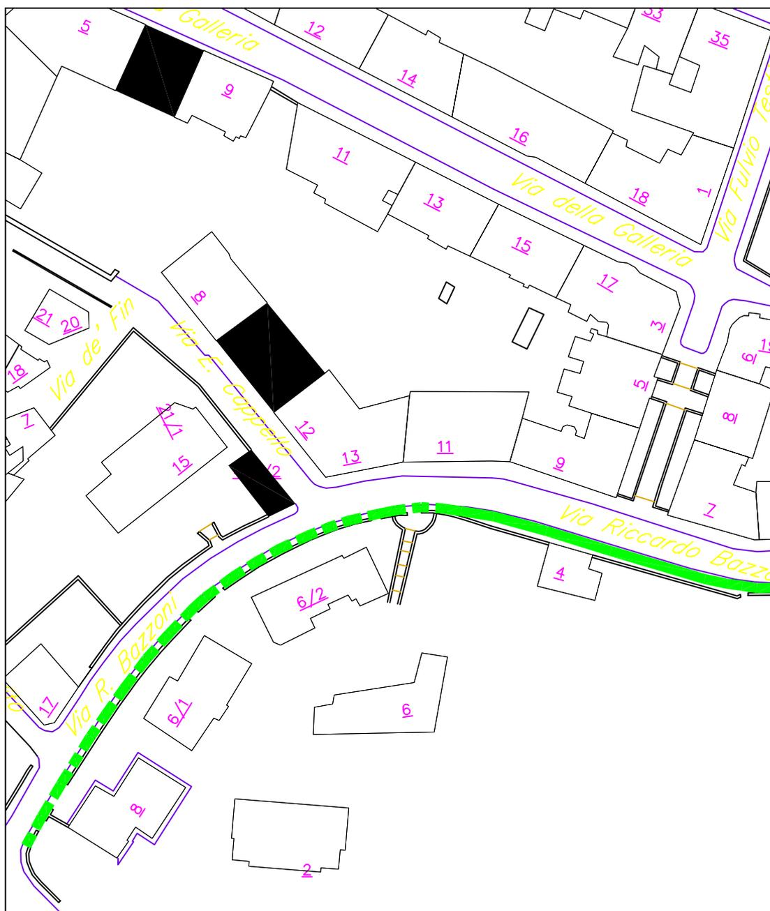
Rifacimento del marciapiede a tratti solo tappetino a tratti completo con demolizione del sottofondo e sostituzione delle cordonate in pietra arenaria.
